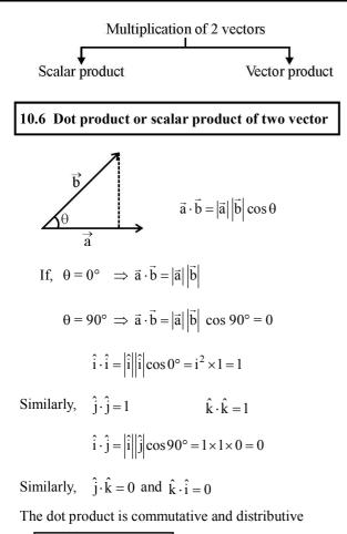
$\vec{a} \cdot \vec{b} = \vec{b} \cdot \vec{a}$  $\vec{a} \cdot (\vec{b} + \vec{c}) = \vec{a} \cdot \vec{b} + \vec{a} \cdot \vec{c}$
