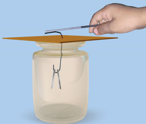
Fig 15.4 : A simple electroscope
